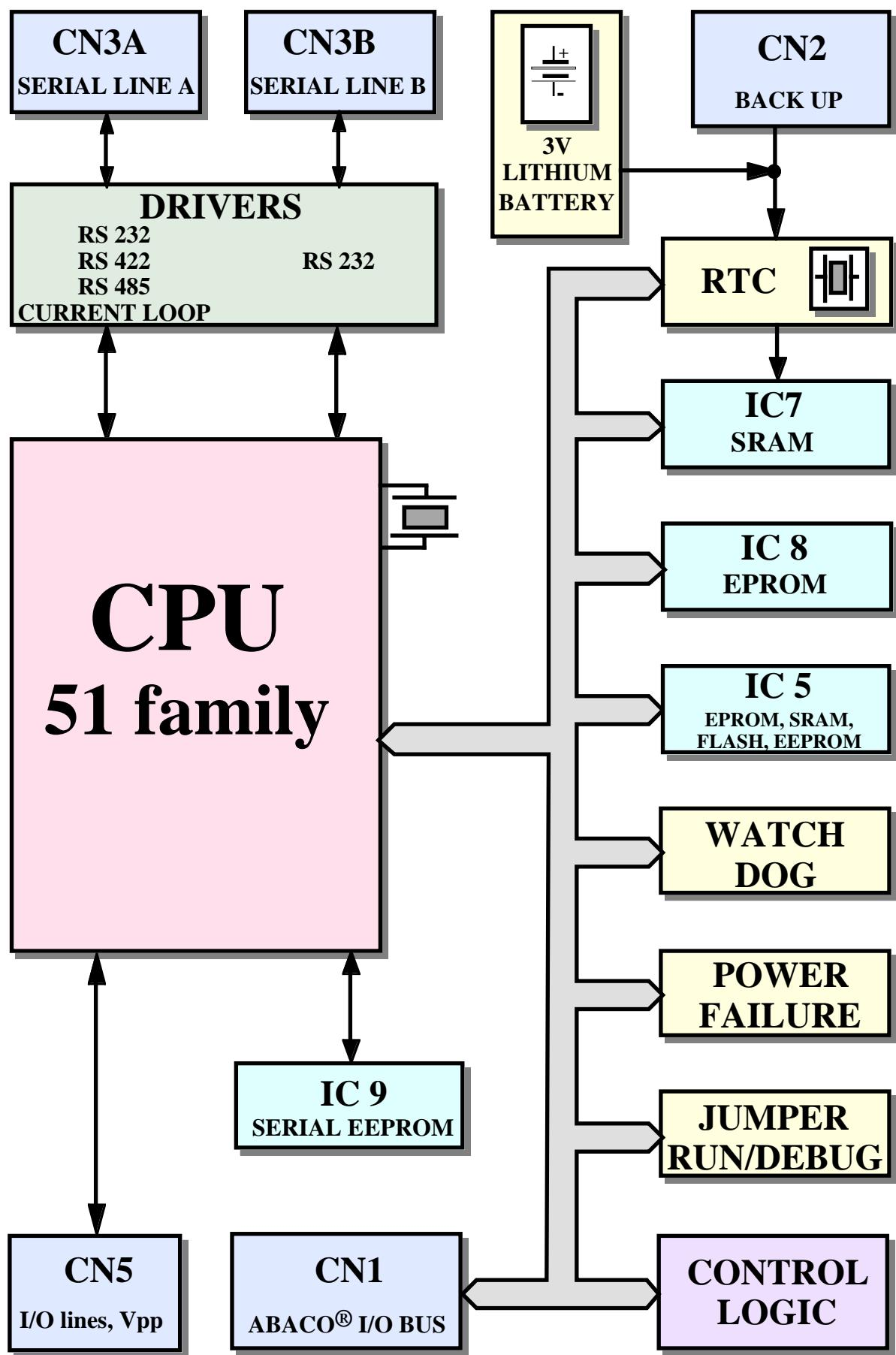
FIGURE 2: BLOCK DIAGRAM
