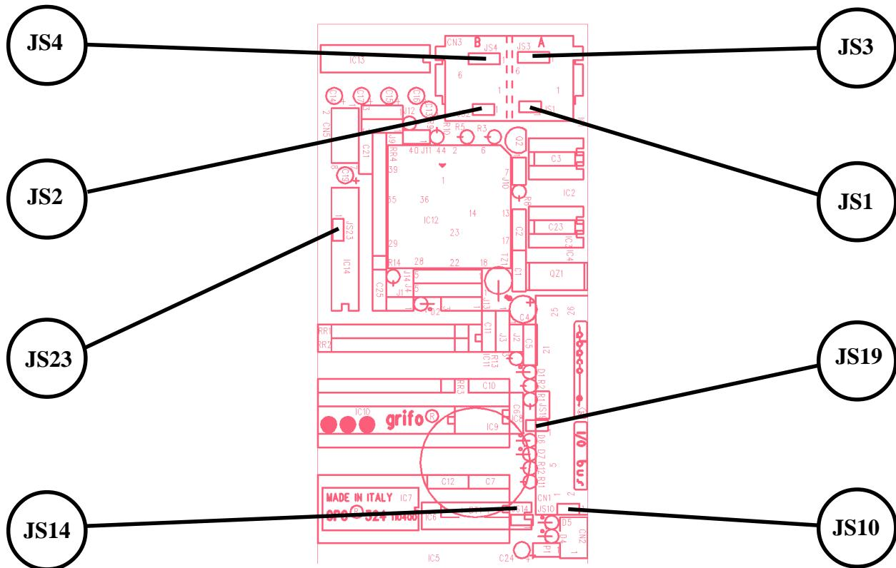
FIGURE 23: JUMPERS LOCATION (SOLDERING SIDE)
