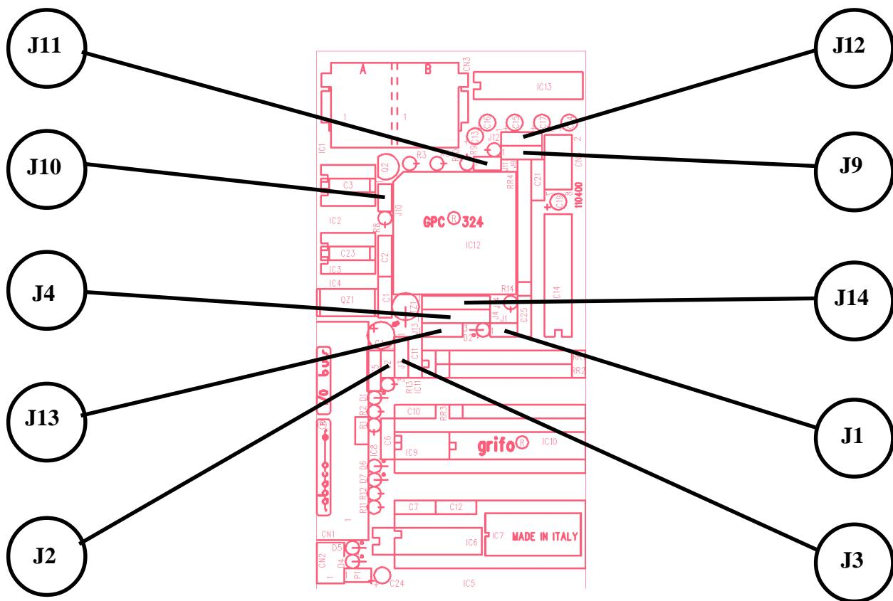
FIGURE 22: JUMPERS LOCATION (COMPONENT SIDE)
