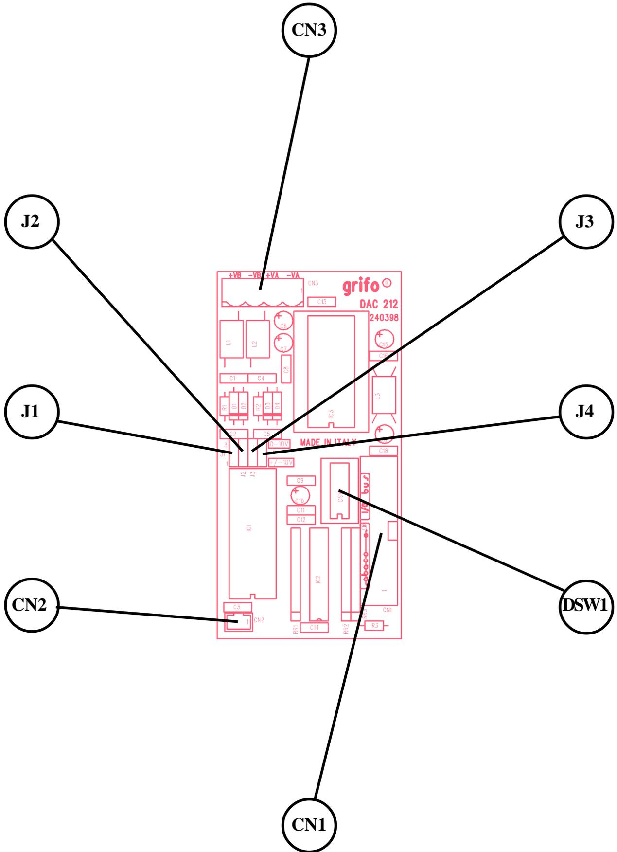
FIGURE 5: JUMPERS, DIP SWITCH, CONNECTORS, ETC. LOCATION
