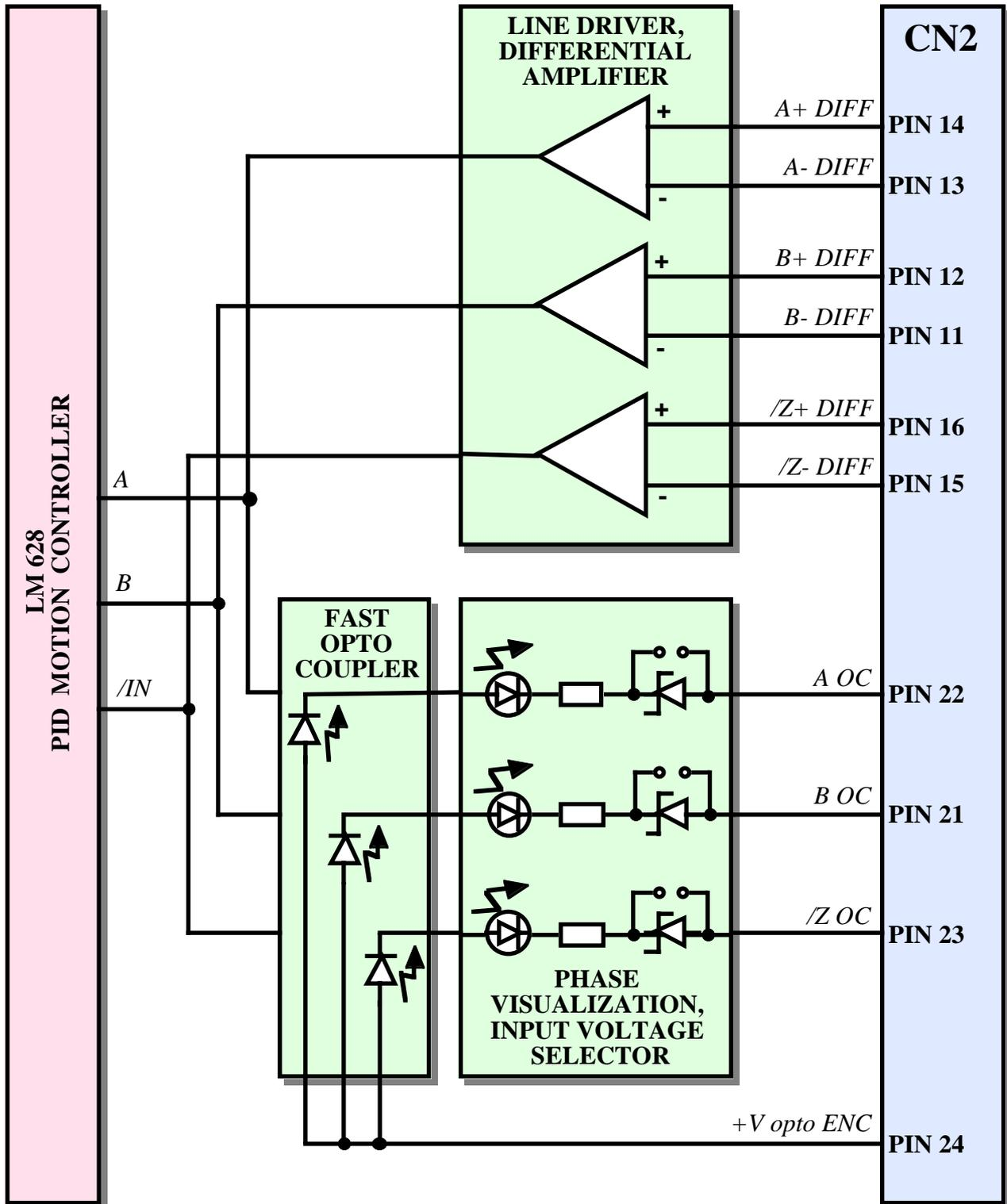
FIGURE 7: ENCODER INPUTS BLOCK DIGRAM
