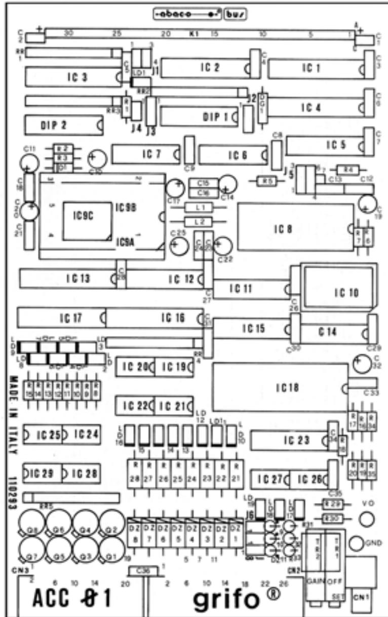
FIGURE 20: COMPONENTS MAP SOLDER SIDE
