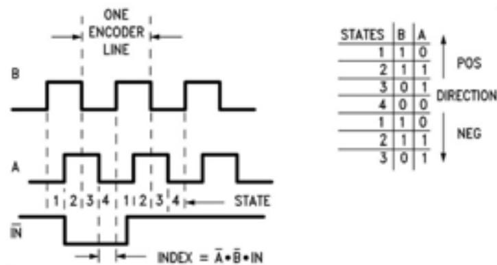
**FIGURA 12: WAVEFORMS OF BIDIRECTIONAL INCREMENTAL ENCODER SIGNALS**
