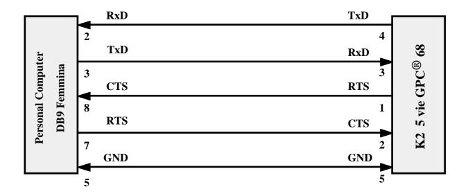
Collegamento seriale tra P.C. con connettore DB9 e GPC® 68
