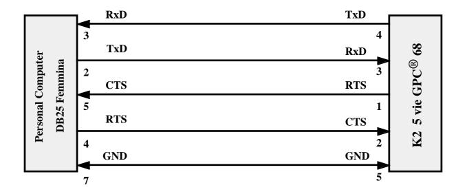
Collegamento seriale tra P.C. con connettore DB25 e GPC® 68
