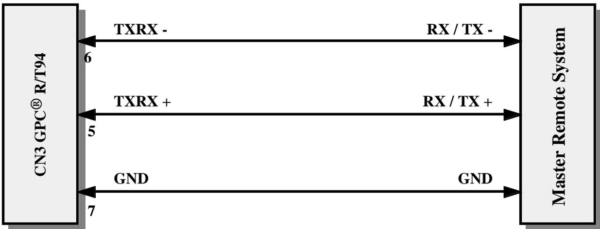
FIGURA 14: ESEMPIO DI COLLEGAMENTO PUNTO PUNTO IN RS 485
