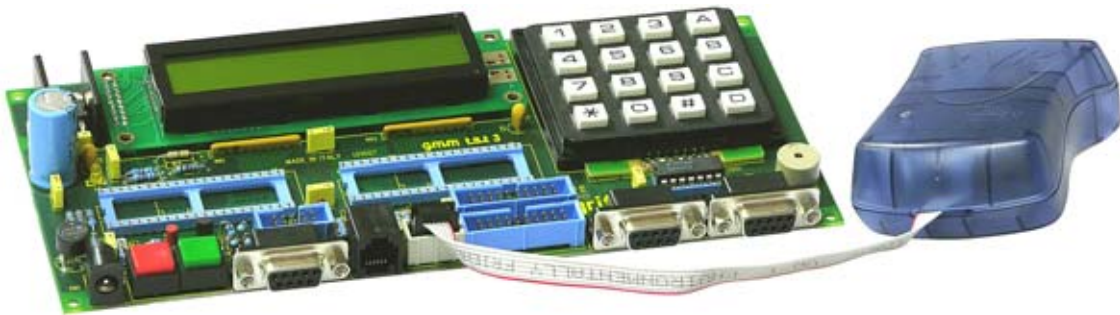
FIGURA 19: COLLEGAMENTO TRA GMM TST 3 E AVR ISP MKII
