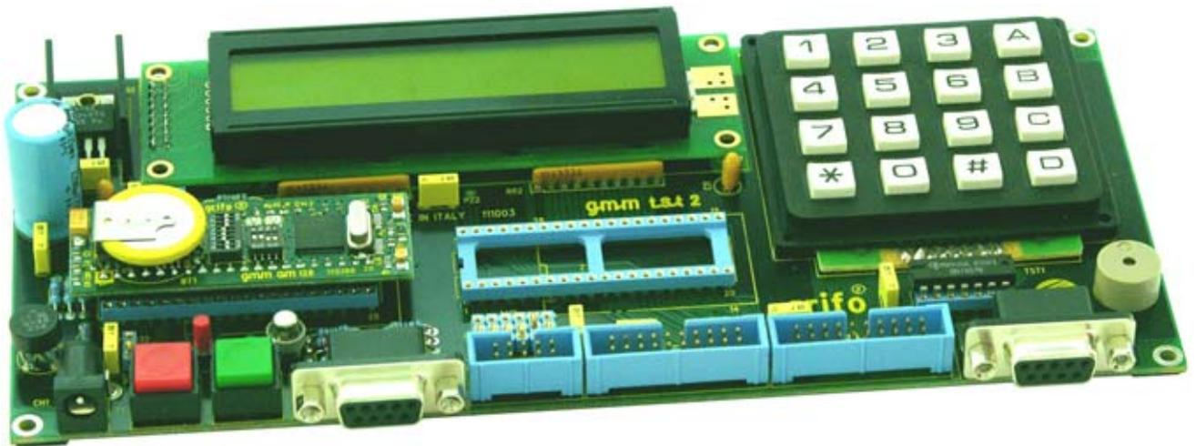
**FIGURA 14: SCHEDA DI SPERIMENTAZIONE GMM TST 2 CON MONTATO UN GMM AM128**
