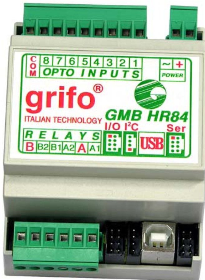
FIGURA 14: GMB HR84 - MODULO PERIFERICO DA CAMPO ADATTO ALLA GMM 518 ZERO
