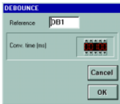
Fig. 11 - Impostazione del tempo di integrazione del componente DEBOUNCE
