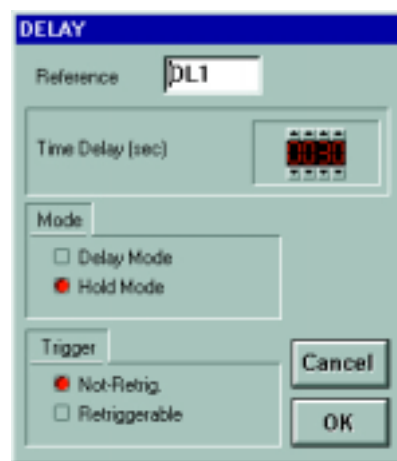
Fig. 5 - Configurazione del componente DELAY per il circuito luci scale
