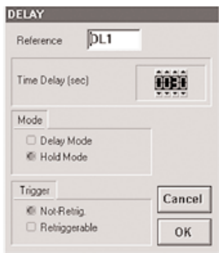
Figura 5 - Configurazione del componente Delay per il circuito luci scale
