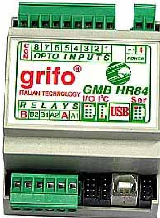
*Un GMB HR84 con 8 Ingressi Optoisolati e 4 Relay di Uscita.*
